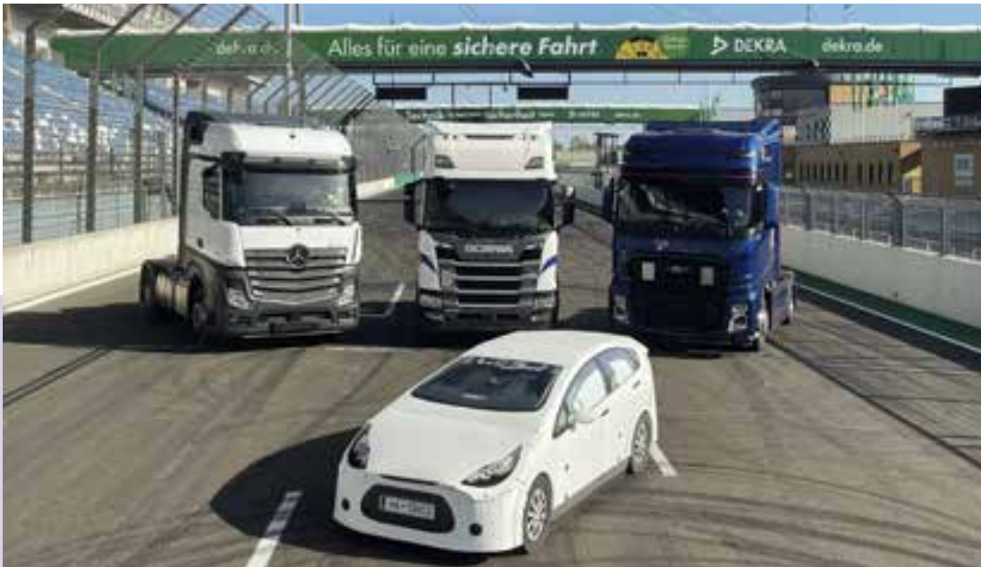
Im Rahmen von Fahrversuchen mit Sattelzugmaschinen von drei Lkw-Herstellern testete DEKRA die Wirksamkeit des jeweils verbauten Notbremsassistenten.
